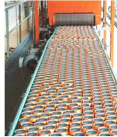
**Tous les moteurs sont des moteurs asynchrones à vitesse variable**, asservis à la cadence des soutireuses et à de multiples autres paramètres : l'usine compte **plusieurs centaines** de variateurs électroniques !
