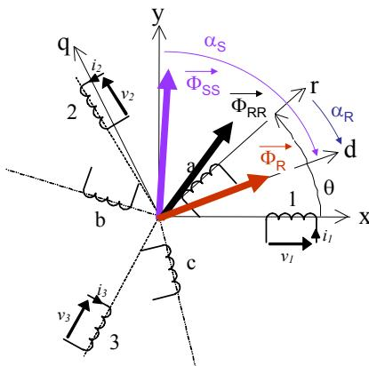
On constate que (par rapport à la machine synchrone) le flux statorique ne peut plus être perpendiculaire au flux rotorique.
