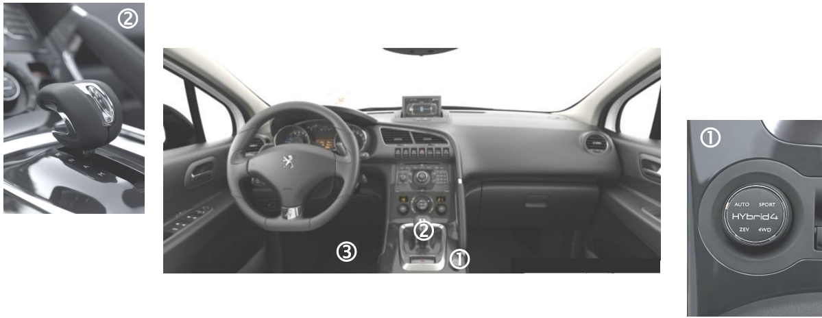
Figure 109 Action conducteur sur le véhicule ① Sélection du mode, ② Boîte de vitesse, ③ Pédales d'action
