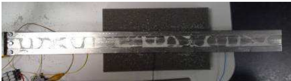
Figure II.12 – Les noeuds pour la fréquence de 21729Hz
