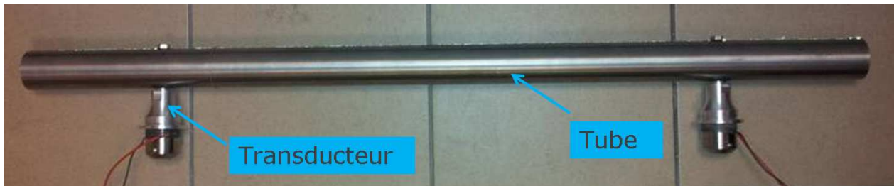
Figure IV.11 – Montage complet : tube avec les deux transducteurs
