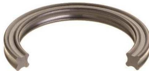
**Figure 2.13** - Illustration d'un joint quadrilobe [Satoriseal 09], la section comporte quatre lobes qui offre une bonne étanchéité avec des frottements réduits à moitié par rapport au joint torique classique [Chevalier 03].
