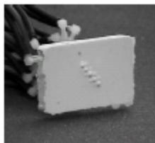
fig. 1-16: Buses à expulsion d'air déformant une matrice de chambres en silicone [httf].
