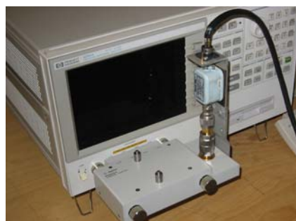
Figure II. 2 : Pont d'impédance HP 4294A muni du socket HP42942A et du balun
