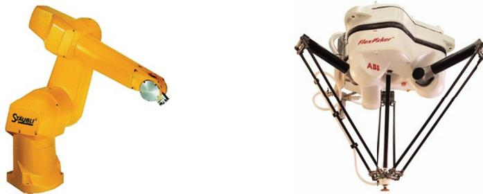
Figure 5 : Robots (a) antropomorphe - série et (b) araignée - parallèle
