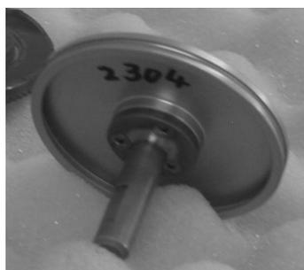
FIG. C.4 – Détail du rotor en duralumin.
