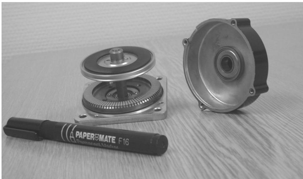
FIG. C.2 – Vue éclatée du moteur.
