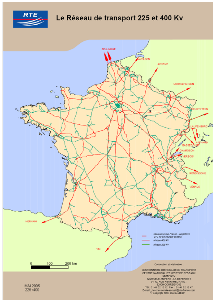
Fig. 2.2. Les réseaux 400 kV et 225 kV [RTE00].
