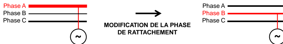
Figure 1-11 Illustration du rééquilibrage des phases BT.
