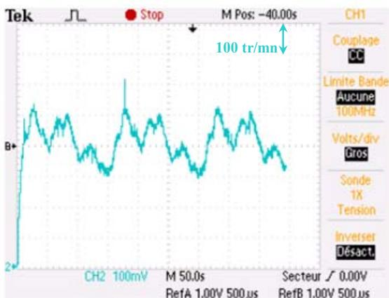
(c) Vitesse mécanique de la machine.
