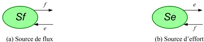
Fig. A.1. REM d'une source d'énergie.
