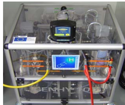
Système d'électrolyseur étudié (CETH GENHY 500W)
