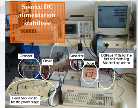
Emulateur de la pile à combustible
