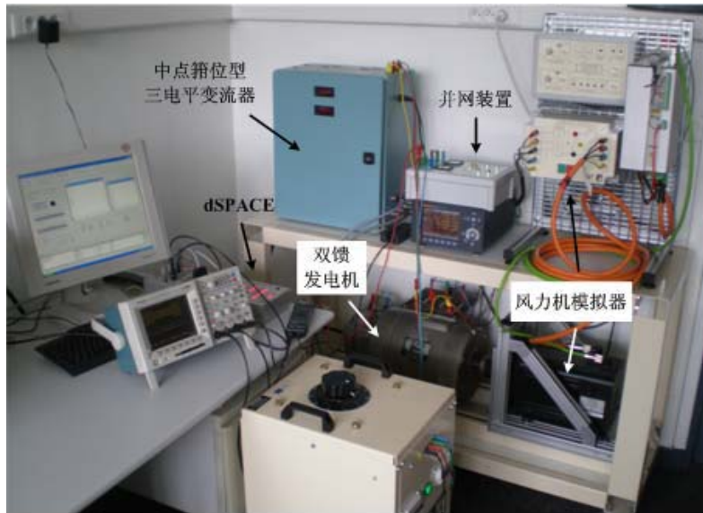
图 5.17 4.5kW 双馈风力发电系统实验平台
