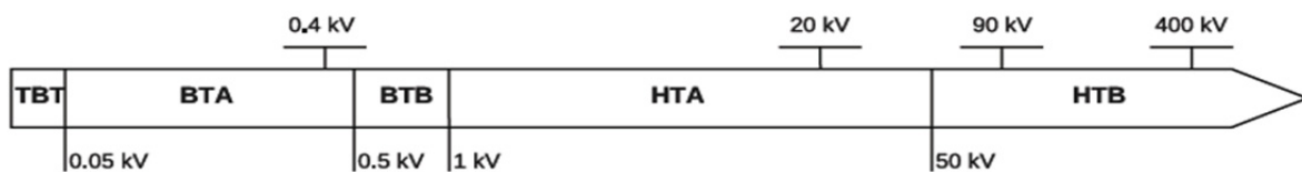
Fig. 1.14. Normalisation des différents niveaux de tension
