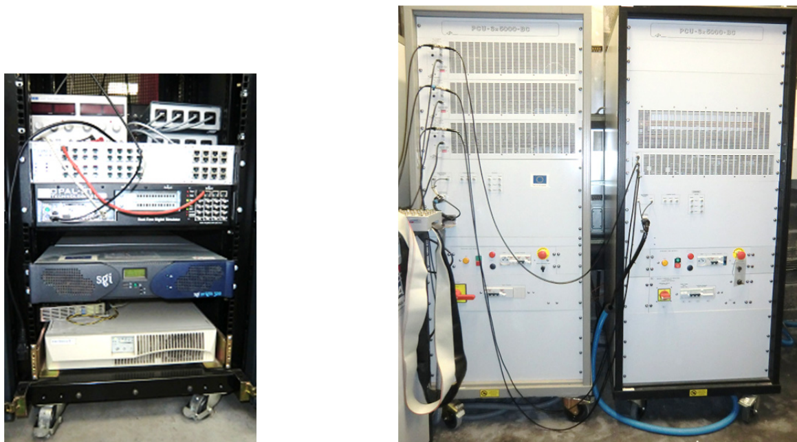
a) Calculateur RT-LAB ® à cœurs parallèles b) Amplificateur de puissance (2 x 15kVA)
